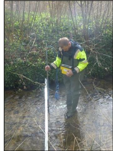
Photographie 1 : Mise en évidence d'une prise de mesure ponctuelle de débits (Source : PCM Eau et Environnement)
